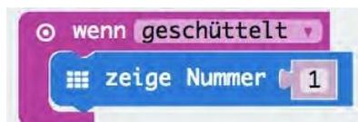
Damit der micro:bit die Schritte zählt, muss das Programm oben erweitert werden. Dazu muss mit einer Variablen gearbeitet werden. Der Wert der Variablen wird dann bei jedem Schütteln erhöht. Die Programmierumgebung bietet dazu einen eigenen Baustein an
